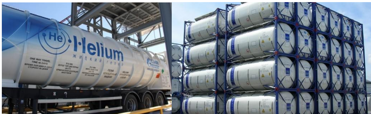
Рис. 5.10 Изотермические резервуары для перевозки сжиженного гелия 16
